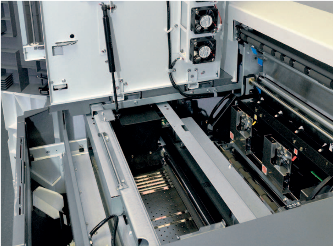
► Das geöffnete Deck gibt den Blick ins Geräteinnere frei. Von links nach rechts sind Teile des Einzelblatteinzugs, des Printerdecks, die beiden Rückseitendrucker für den Bilddaten- druck und der Papierauslauf zu sehen. Abb.: fe
