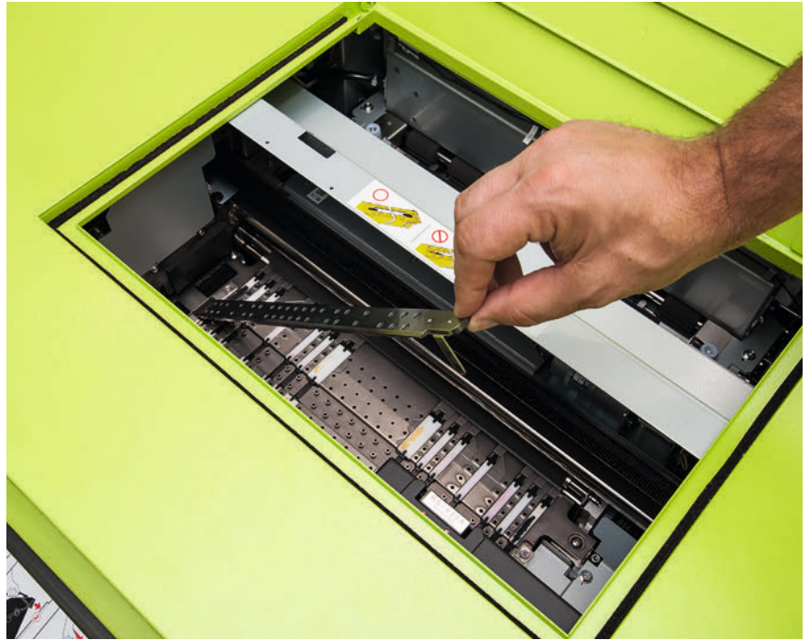
► ... die – das ist neu – mit einer querliegenden Spange zusätzlich gesichert werden. Die Spange wird mittels Magnetverschluss gesichert. Abb.: fe
