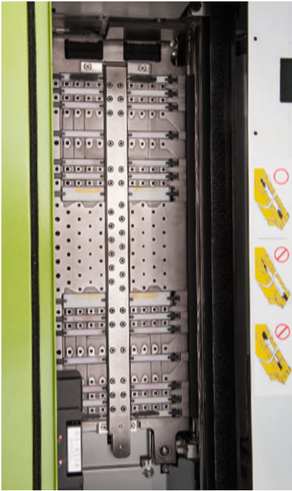
► Die gelochte Druckplatte des Green IV, auf der das Papier beim Bedrucken per Unterdruck fixiert wird, ist mit flexiblen Absorbieren bestückt, ... Abb.: fe
